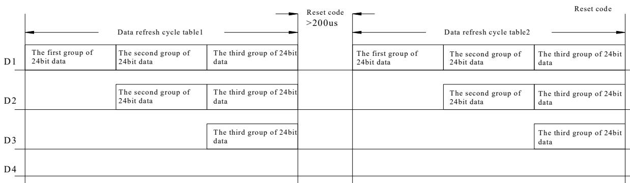
注Note：其中D1为MCU端发送的数据，D2、D3、D4为级联电路自动整形转发的数据。
