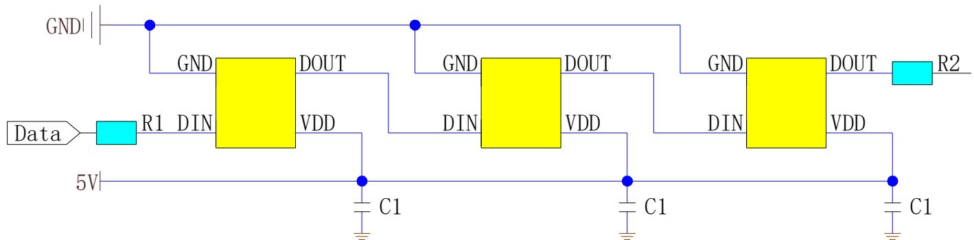
在实际应用电路中，为防止产品在测试时带电插拔产生的瞬间高压损伤IC内部信号输入输出引脚，应在信号输入及输出端串接保护电阻。此外，为了使各IC芯片间更稳定工作，各灯珠间的退偶电容则必不可少；
